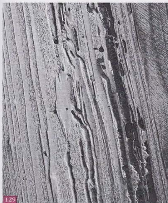
Les dégâts du capricorne: de la nécessité de choisir un bon traitement
